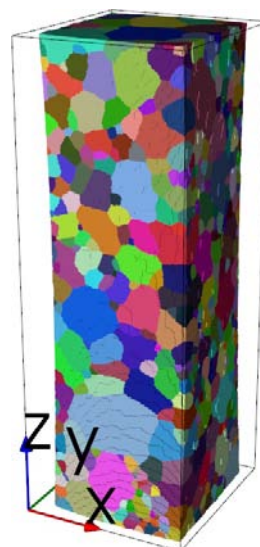
Reconstruction 3D par tomographie en contraste de diffraction de la microstructure polycristalline d'un échantillon d'aluminium-lithium (0,5 mm x 0,5 mm x 1,2 mm).
