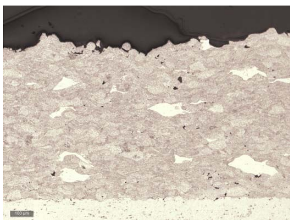
Dépôt d'aluminium 2024 sur un substrat d'aluminium 2024 T3 réalisé par "cold spray"
