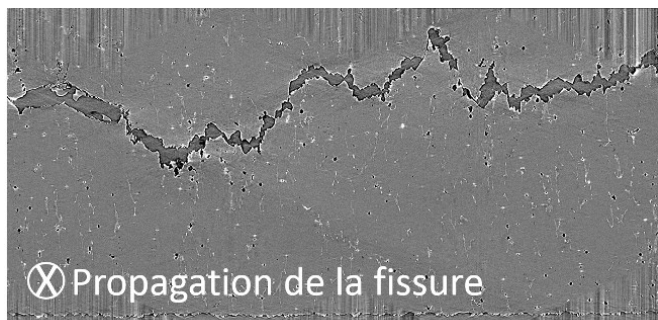
Propagacion d'une fissure.
