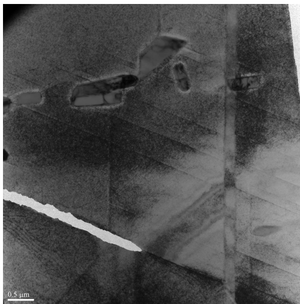
Figure 1 : Observation au MET de la fissure sur joint \Sigma 3
