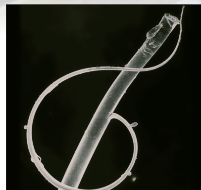
• RUPTURE EN FATIGUE D'UNE FIBRE POLYESTER.
