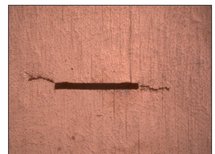
• SUIVI OPTIQUE DE PROPAGATION DE FISSURE D'UN DÉFAUT DANS UN ALLIAGE D'ALUMINIUM.
