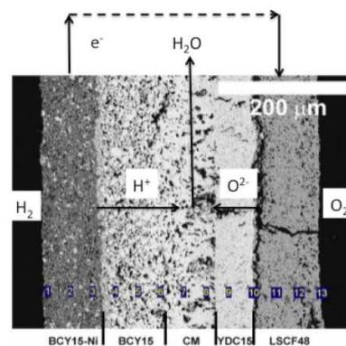
Membrane duale de la pile à combustible IDEAL CELL obtenue par coulage en bande (5 couches)
