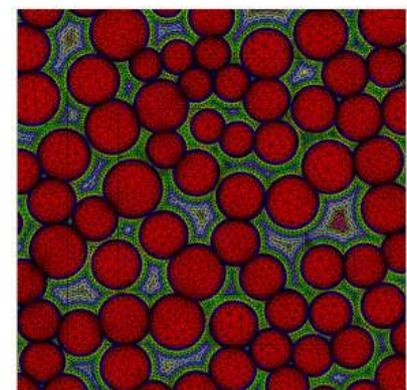
Maillage d'un composite (coupe perpendiculaire à la direction des fibres) en vue de modélisation des effets d'interphase et de contacts.
