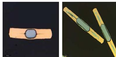
*Fil rond bimétallique Cu/W ou trimétallique Cu/Ni/W mis en forme avec un endommagement par fissuration réduit par colaminage en plusieurs passes (projet européen ERFTM)*
