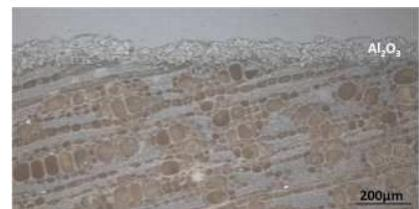
Coupe d'un dépôt Al<sub>2</sub>O<sub>3</sub> sur bois obtenu par projection plasma.
