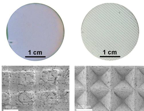
(En haut) Couples anode/électrolyte de piles de type SOFC à interfaces plane et architecturée. (En bas) Intégration de motifs périodiques de géométrie parallélépipédique et pyramidale sur la surface d'une anode support
