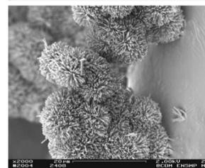
de haut en bas: microparticules d'hydroxyde de cobalt, d'hydroxyde de nickel et d'oxyde de zinc obtenues par précipitation homogène.
