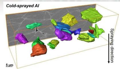
Image 3D de la structure interne d'un dépôt d'Al obtenu par cold spray montrant une sélection des particules écrasées le constituant.
