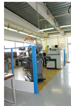
Allées de circulation matérialisées autour de la zone de fraisage, isolée sur ses flancs par des panneaux transparents.
