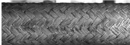
Vue extérieure d'un tube SiC/SiC-CVI tressé 2D utilisé dans l'étude
