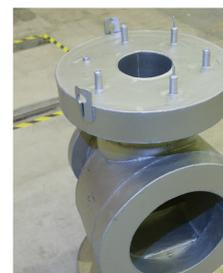
Conteneur rempli de poudre avant l'opération de compaction isostatique à chaud ou HIP
