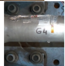
Instrumentations d'un tube de 30 mm avec des jauges de déformations circonférentielle [Nexter Systems]
