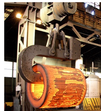
Manipulation d'une virole au cours du forgeage (document Areva Creusot Forge)
