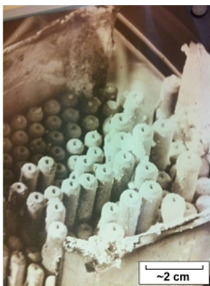
Gonflement d'acier 316 hypertempéré - Assemblage Rapsodie - D'après J.L. Seran
