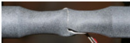
Rupture instable d'un tube en acier maraging en torsion (source: Snecma)
