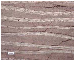
Fissures au sein du matériau (PEEK renforcé par des fibres de carbones) suite à un essai de flexion 3 points rapprochés.
