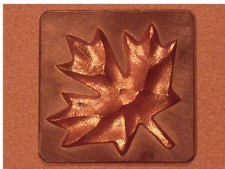
Fig.2 : Feuille d'érable canadien réalisée par dépôt cold spray de cuivre sur plaquette inox, 5x5cm<sup>2</sup> : produite par A. Shkodkin, OCPS, Russie, conférencier à CCSC.
