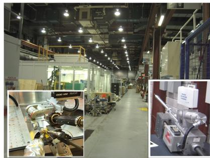
Fig.3 : Halle de projection thermique au NRC/Boucherville. Insert gauche : zoom sur tête de projection cold spray. Insert droit : zoom sur nouveau système de projection SST (« Supersonic Spray Technologies ») par Centerline/Windsor-Canada.
