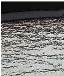
Gradient de distribution d'hydrures dans l'épaisseur d'une gaine en fin de vie.
