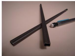
Figure 2 : Buses pour cold spray réalisées par fabrication rapide laser (SLM).
